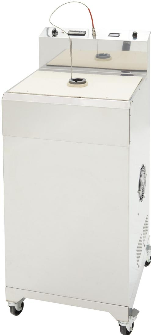
La fonditrice elettronica a media frequenza **ATOOM** utilizza crogioli in grafite. La potenza del generatore è regolabile ed è visualizzata da un indicatore digitale, un basso consumo di energia risalta l'alto rendimento del generatore. La temperatura è controllata da un termoregolatore digitale e la termocoppia è inserita direttamente nella grafite del crogiolo.
